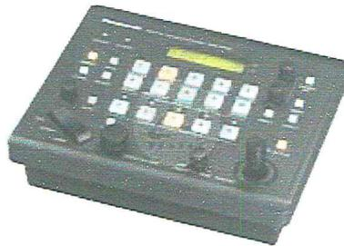
Kompaktes Steuerpanel für Schwenk-Neigesystem
