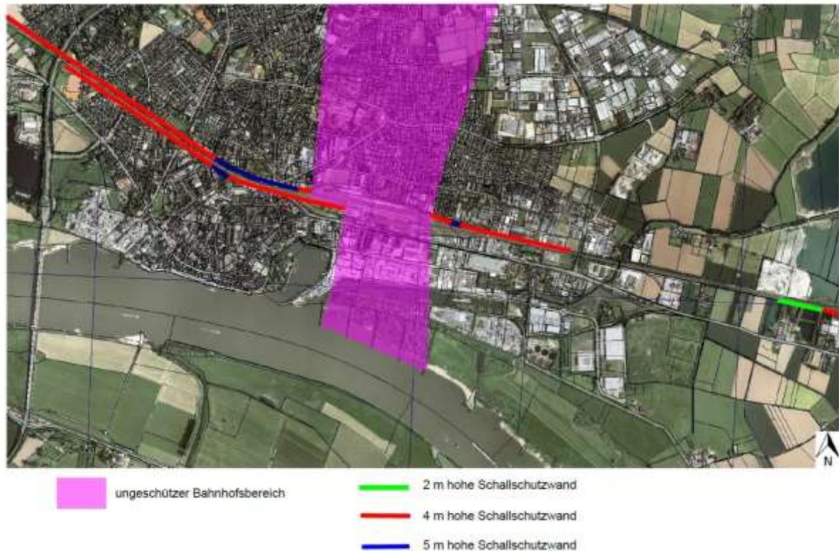
**Abbildung 26 Luftbilddarstellung: Übersicht der Schallschutzwände in Emmerich**
