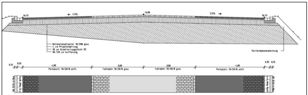
Abb. 7: Querschnitt der Stellplatzfläche
