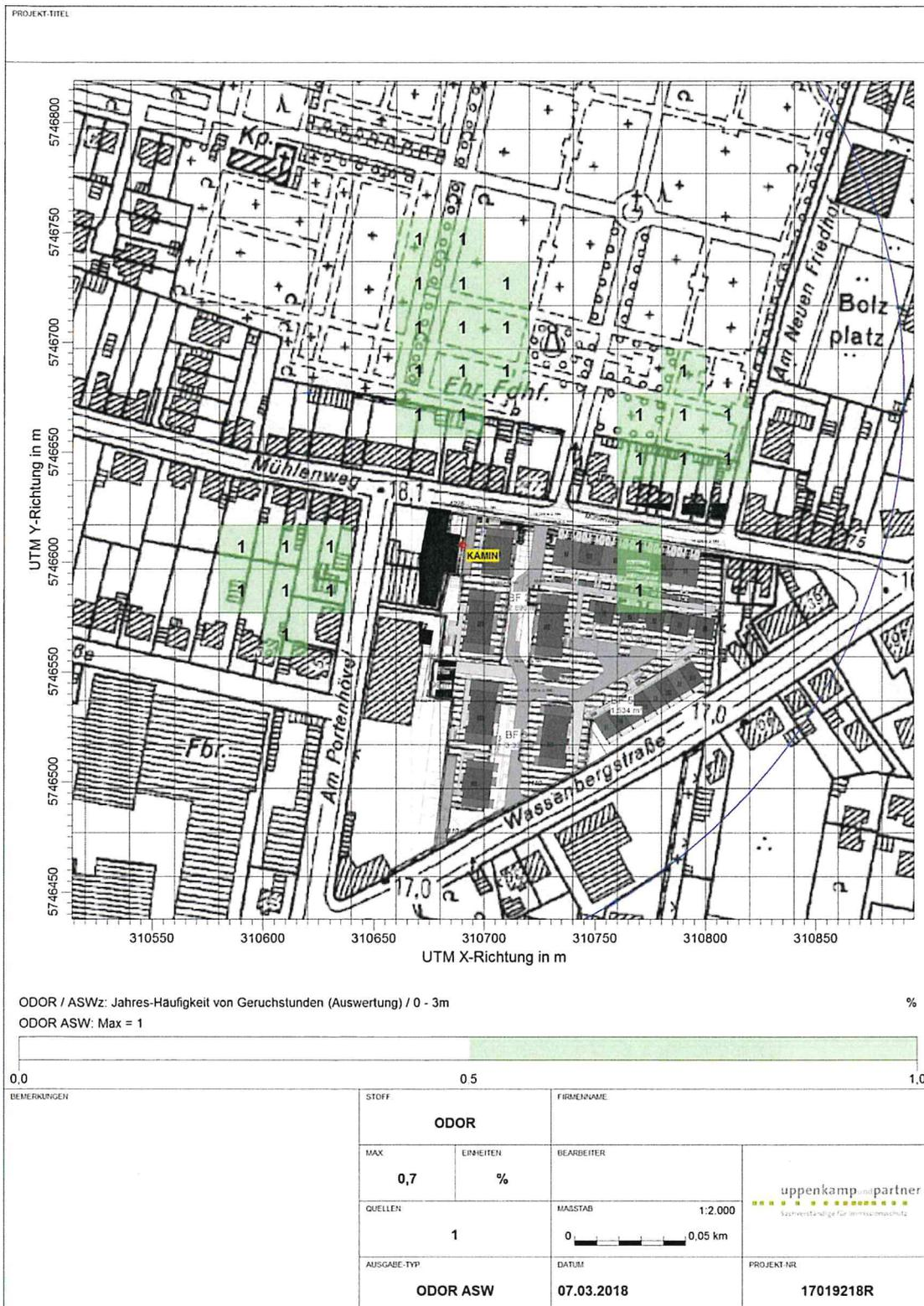
Abbildung 6: Zusatzbelastung durch den Kamin im Plan-Zustand in % der Jahresstunden, Rasterschrittweite 20 m
