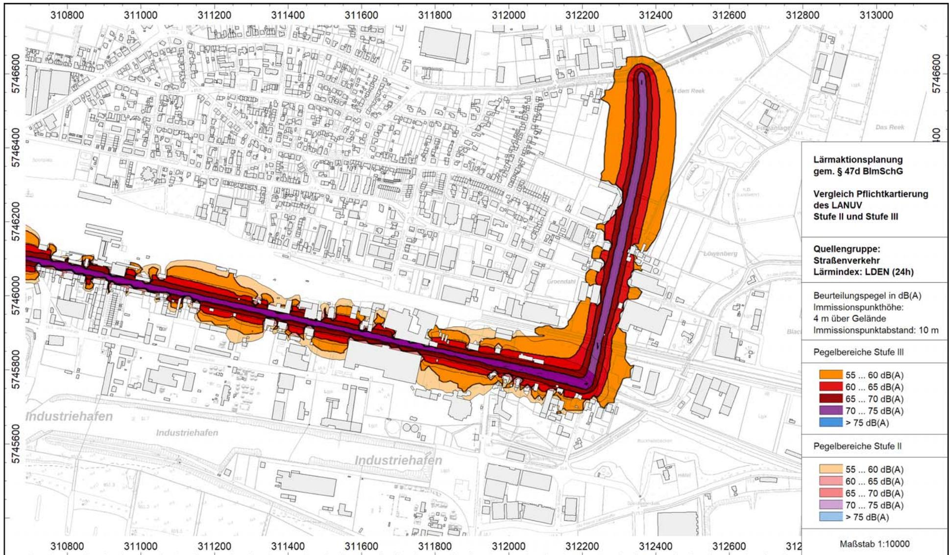
**Abb. 5.1.5** Gegenüberstellung der Kartierungsergebnisse des LANUV für die Stufe III und Stufe II - Lärmindex L<sub>DEN</sub> - Bereich südl. L 90
