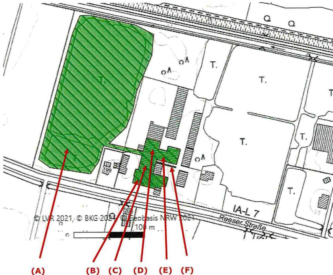
Kartierung des Schutzzumfangs mit Tonteichen (A), südlicher Ofenanlage (B), Trockenkammern (C), Produktionshalle (D), Produktionshalle für Sonderformate und zweite Ofenanlage (E) sowie Gleisanlage (F).
