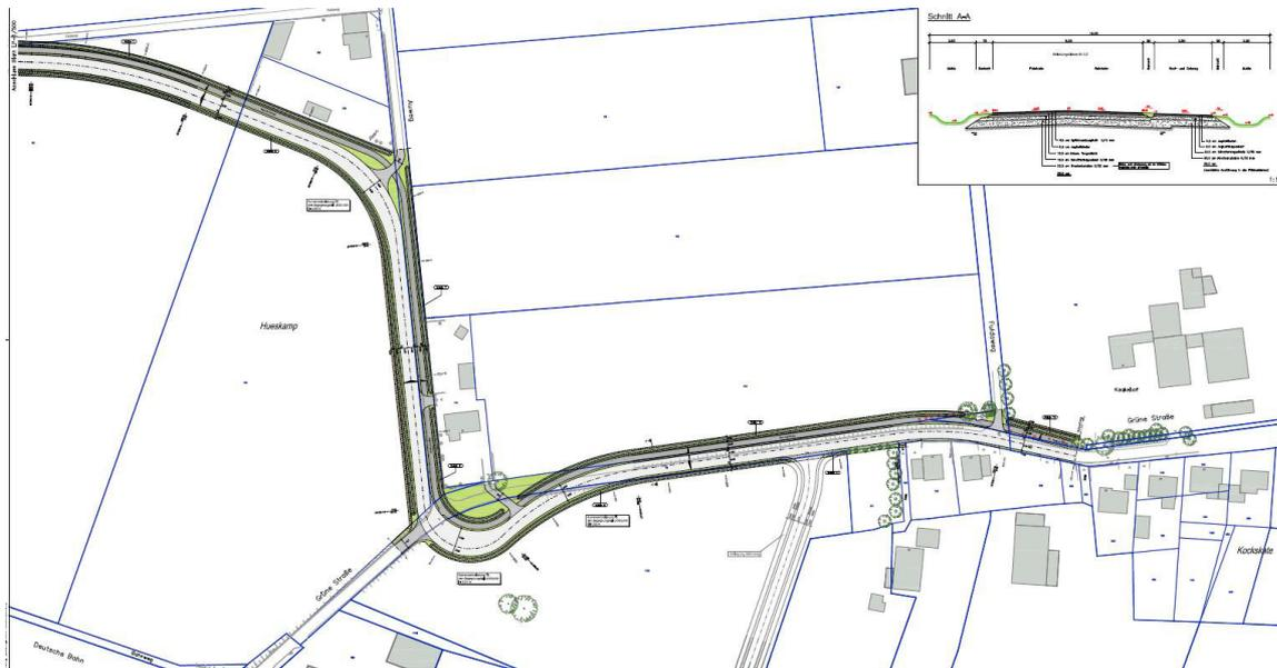
Die Stadt verfolgt das Ziel, eine sichere Verbindung für alle Verkehrsteilnehmer, insbesondere für Fußgänger und Radfahrer zu errichten, da dies eine Haupt-Radverbindung zwischen Praest und Emmerich darstellen wird. Aufgrund dessen ist entlang der geplanten 6,50 m breiten Fahrbahn für PKW ein Rad- und Gehweg mit einer Breite von 2,50 m geplant.
